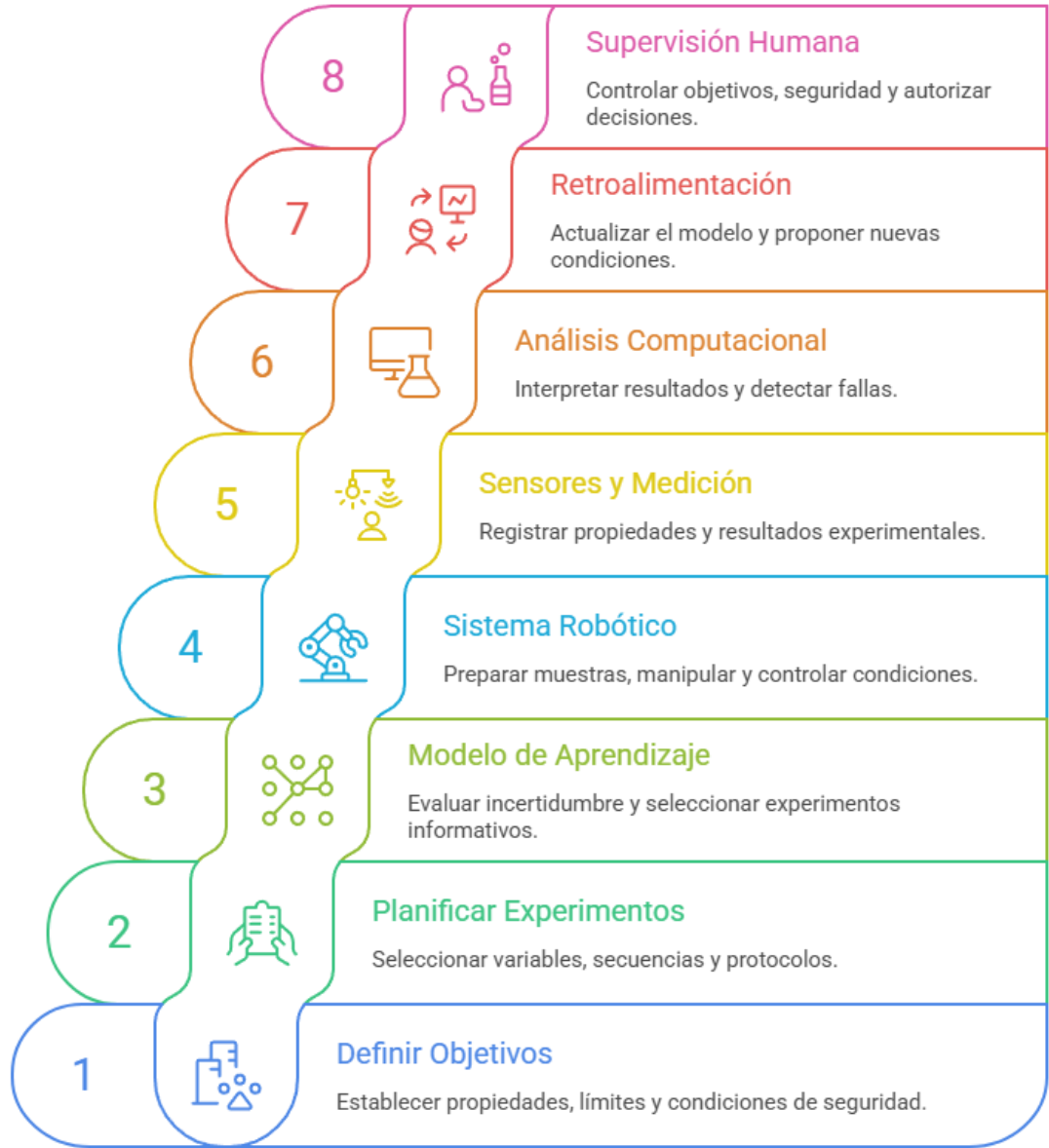
Figura 10 Arquitectura general de un laboratorio autónomo
